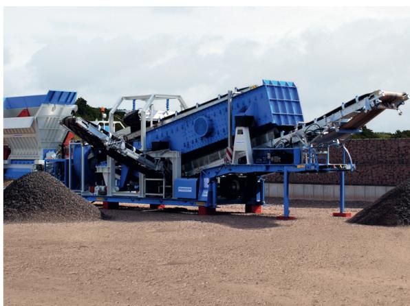
Abb. 5: Granulierung von Asphalt
